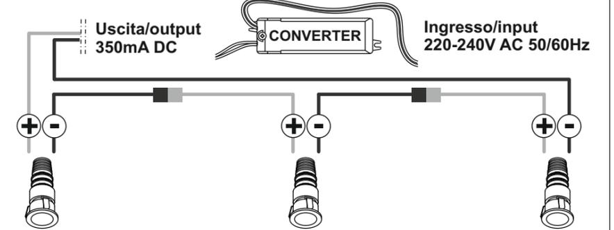
Montaggio dell'alimentatore: remoto - Converter mounting: remote -
