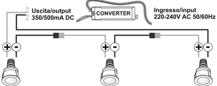
Montaggio dell'alimentatore: remoto - Converter mounting: remote -
