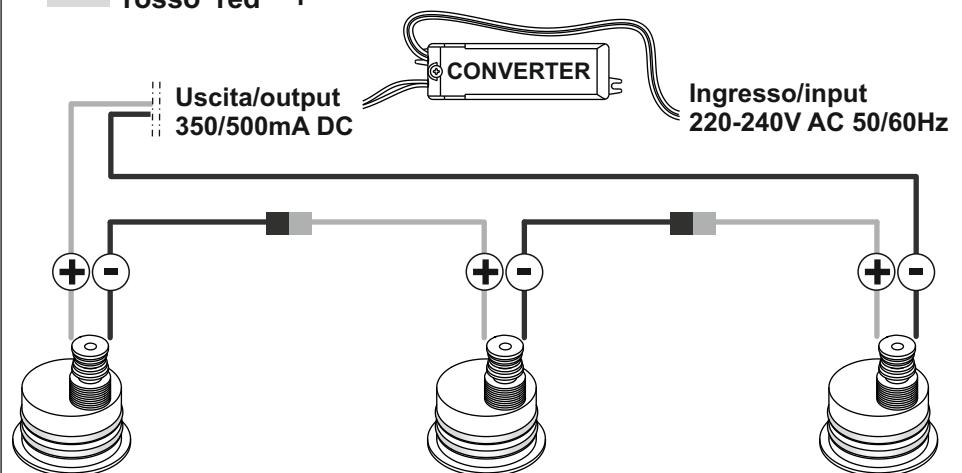
Montaggio dell'alimentatore: remoto - Converter mounting: remote -
