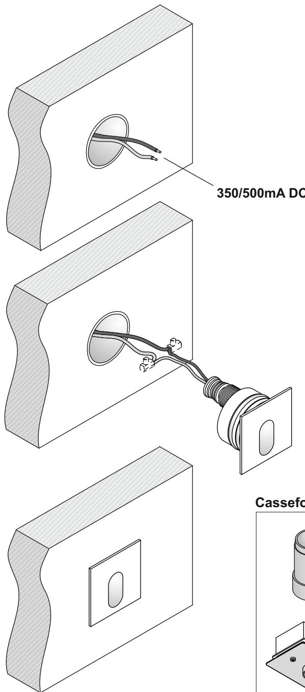
Collegamento in serie - Series connection - Connection en série
